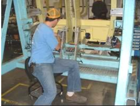
Photo 2 : exemple de gabarit empêchant l'employé de placer ses jambes devant, travaillant ainsi en torsion.
