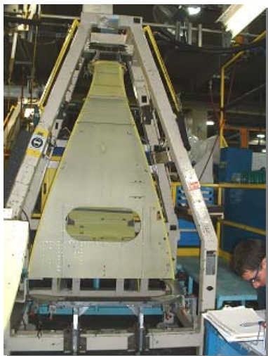
Photo 1 : le gabarit est en gris et la pièce à percer/riveter est en jaune.
